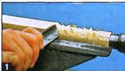
1 Грубую обработку заготовок квадратного сечения сначала делают обдирочным резцом.
