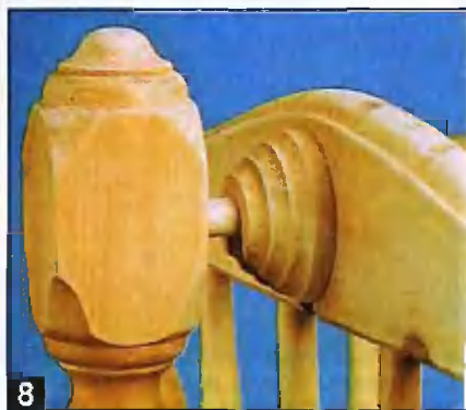
8 Конструкция подвески позволяет легко снять колыбель с основания.
