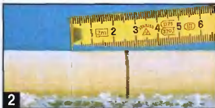
2 Складной метр, доработанный таким образом, облегчает разметку заготовок.
