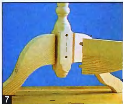
7 Детали основания собирают на буковых шкантах с клеем.
