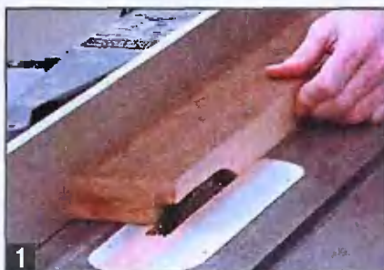
1 Выборка на циркулярной пиле шипов, боковых фальцев ...
